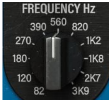
Potentiomètre de réglage de fréquence du filtre
